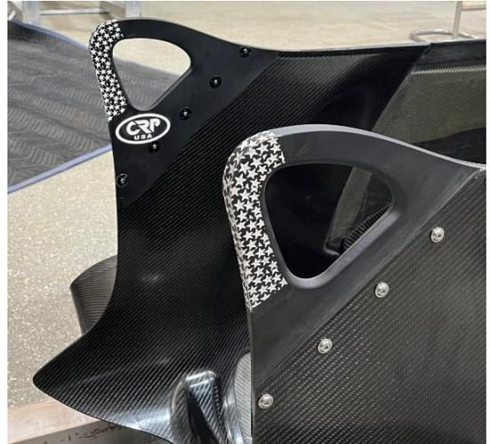
Realizzati in materiali compositi caricati con fibra di carbonio Windform SP e Windform XT 2.0 di CRP Technology, i componenti stampati mediante Sinterizzazione Laser Selettiva (SLS) comprendono maniglie di spinta, impugnature e sedili, assicurando maggiore resistenza allo stress, flessibilità, robustezza e facilità di cambio.
