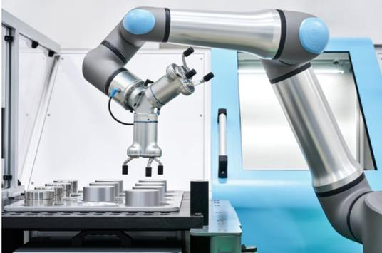
Universal Robots ha presentato la nuova versione UR30 del suo robot collaborativo (cobot), ora in grado di gestire carichi più pesanti (la capacità arriva a 30 kg con piena estensione) e compiere operazioni di avvitatura a coppia elevata, pur mantenendo dimensioni compatte.
