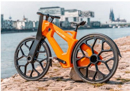
Questi sviluppi industriali sono resi possibili grazie al lavoro condotto sul prototipo di bicicletta igus:bike, interamente in materiale plastico con telaio e ruote ottenuti da rifiuti post-consumo, progettata da igus e prodotta dalla società olandese mtr.
