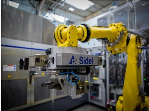
Con l'obiettivo di incrementare l'efficienza dei suoi impianti per il soffiaggio di bottiglie EvoBLOW, Sidel ha progettato un sistema per il cambio rapido del formato, Bottle Switch, da applicare agli alimentatori gravimetrici di preforme, ai forni e alle ruote di soffiaggio.
