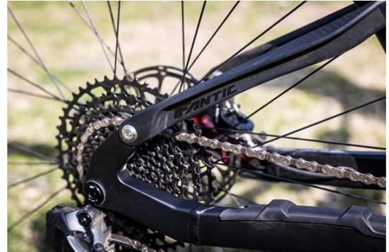
Il pezzo che ha beneficiato dell'intervento di metal replacement è il puntone, componente strutturale del telaio realizzato per la prima volta in poliammide anziché in alluminio, offrendo una migliore risposta del carro posteriore alle sollecitazioni del terreno. Il componente in materiale plastico è anche più leggero del 10% e non richiede verniciatura, poiché colorato in massa, finito all'uscita dello stampo.
