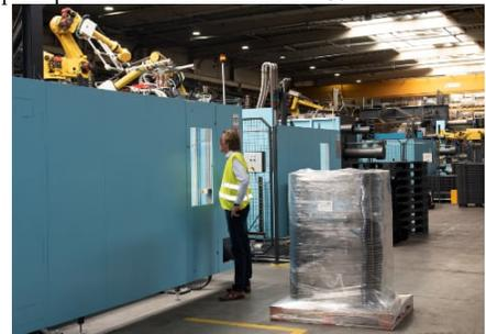
Le due nuove presse sono state recentemente dotate di stampi multipiano in cui vengono iniettate le parti del pallet, superiore e inferiore, successivamente assemblate a incastro. "Attualmente ci serviamo di stampi di questo tipo, che vengono utilizzati per la produzione di pallet chiusi" nota Vally Hoogland.
