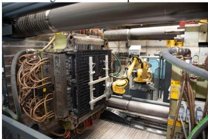
Nei casi in cui è possibile operare con pressioni basse, in alternativa alla seconda vite si utilizza un pistone con il quale si riescono a stampare pezzi di grandi dimensioni (contenitori, pallet o raccordi), con peso stampato fino a 160 chilogrammi.
