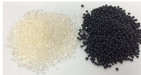
I compound di PVC flessibile possono contenere fino al 90% di materiale riciclato, possiedono proprietà simili a quelli dei gradi a base di PVC vergine e sono forniti in versione trasparente, naturale o nera con diverse durezze in funzione delle specifiche applicazioni, generalmente da 70 a 95 Shore A.
