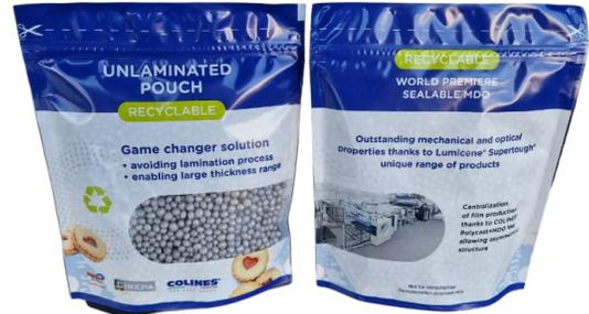
La soluzione sviluppata dai due partner vede l'impiego di due diverse resine polietileniche fornite da TotalEnergies, a marchio Supertough e Lumicene (HDPE), estruse in film cast su una linea Colines Polycast con unità di orientazione in direzione macchina (MDO, Machine Direction Orientation). Si è ottenuta così una struttura asimmetrica, con uno strato sigillante a bassa densità su un lato e un layer rigido ad alta densità sull'altro.
