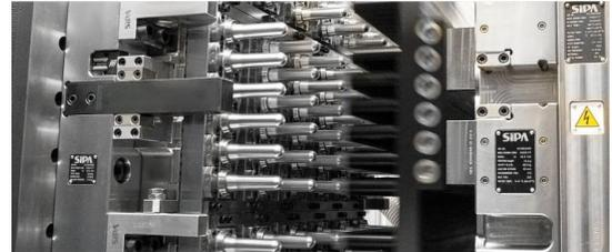
SIPA ha però deciso di infrangere questa regola e, intervenendo sulla configurazione dei canali caldi e sulla progettazione dello stampo, ha introdotto uno stampo a 84 cavità, che può essere montato sulla pressa ad iniezione per preforme Xform 250, con forza di chiusura di 250 tonnellate, al posto del convenzionale stampo a 72 cavità (e senza dover passare alle 96 cavità, più ingombranti), mantenendo la stessa qualità.
