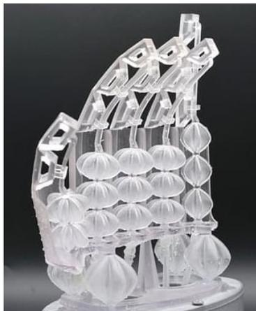
Nell'ambito del progetto europeo Proboscis (Proboscidean sensitive soft robot for versatile gripping), un gruppo di ricerca internazionale, del quale fa parte anche l'Istituto Italiano di Tecnologia (IIT), sta lavorando allo sviluppo di una mano artificiale dotata di "muscoli" pneumatici stampati in 3D con materiale polimerico.
