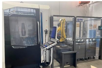
Il nuovo sistema, già in funzione nella sede di Legnano, ha comportato un investimento intorno a 500mila euro, ma sarà in grado di ottimizzare i processi riducendo la presenza degli operatori, poiché il cambio pezzo in macchina avviene attraverso un piccolo robot che consente il funzionamento in automatico.
