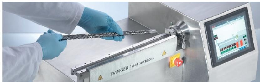
*Il design del Process 11 permette una facile e rapida pulizia di tutte le componenti a contatto con il materiale processato grazie alla possibilità di rimuovere completamente le viti (ed i singoli elementi che la costituiscono) e la parte superiore del barrel.*
