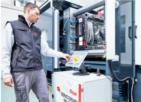
Oerlikon HRSflow ha reso più intuitiva ed ergonomica l'interfaccia uomo-macchina (HMI 4.0) del sistema a otturazione servo-controllata FLEXflow, tecnologia per stampaggio di precisione di particolari plastici in camera calda.
