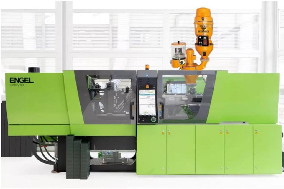
Sulla strada verso una sempre maggiore interazione tra presse e attrezzature ausiliarie, Engel Austria e Werner Koch Maschinentechnik hanno sviluppato una nuova interfaccia per l'interconnessione delle macchine basata sul protocollo di comunicazione OPC UA, di recente normato in ambito Euromap.
