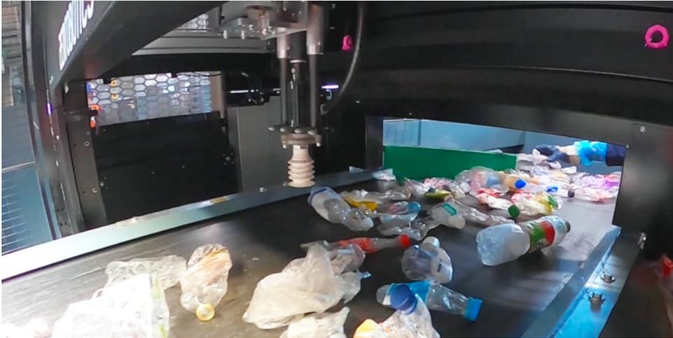
Il centro di selezione e recupero di materie plastiche di Masotina a Corsico, alle porte di Milano, è stato recentemente aggiornato con l'installazione di una nuova stazione di smistamento robotizzata, supportata da intelligenza artificiale (AI), fornita dalla finlandese ZenRobotics.
