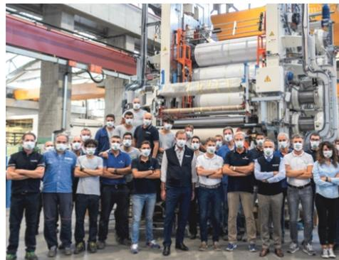
La macchina, attualmente in fase di installazione, ha una larghezza di 2.000 mm ed è stata fornita chiavi in mano, completa di gofratore in linea, gruppo di raffreddamento termoregolato e di tutte le attrezzature ausiliarie necessarie al processo di calandratura.
