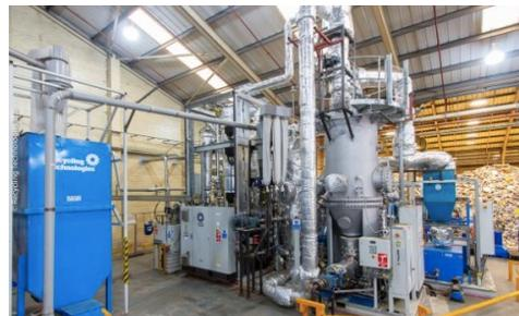
Il processo messo a punto da Recycling Technologies è in grado di trasformare rifiuti plastici difficili da riciclare per via meccanica - come film multistrato, sacchetti e imballaggi laminati - in un olio, battezzato Plaxx, che può essere reintrodotta come feedstock nella produzione di nuove materie plastiche. Le unità RT7000 possono essere anche di piccola taglia e modulari, così da integrarsi negli impianti di selezione e trattamento dei rifiuti.
