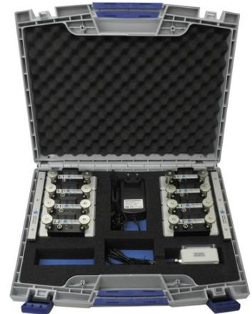
L'App, recentemente aggiornata, permette di visualizzare sia i valori di misura dei singoli sensori, sia l'allungamento compensato in flessione delle 4 colonne della pressa che il loro valore medio. Partendo da questi dati viene calcolata la deviazione standard massima rispetto alla media e l'operatore riceve un avviso qualora vengano rilevate anomalie.
