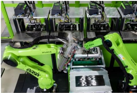
Process. Il costruttore austriaco di presse ad iniezione Engel è stato premiato nella categoria dedicata alle tecnologie di lavorazione dei materiali compositi per lo sviluppo di una linea costituita da una cella di impilamento nastri pick-and-place automatizzata, per la formazione del semilavorato di rinforzo, integrata con un'unità di consolidamento heat&cool che origina un pannello solido e leggero. La linea consente di produrre parti su misura con
