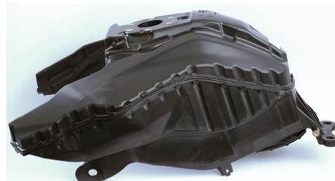
Il materiale selezionato per questa applicazione - Durethan BC550Z 900116 DUSXBL - soddisfa i severi requisiti in termini di permeabilità fissate dall'agenzia statunitense per la protezione ambientale (EPA), pari a 1,5 g/m<sup>2</sup>d (grammi per metro quadrato di superficie al giorno).
