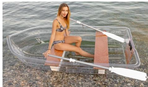
Lunga poco meno di due metri e mezzo per una larghezza di 1,3 metri, l'imbarcazione pesa solo 37 kg e può imbarcare due persone.
