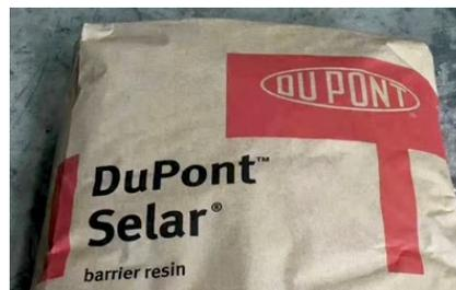
Selar PA 3426R è una poliammide amorfa, trasparente, con buona barriera a ossigeno e CO<sub>2</sub>, umidità, solventi, idrocarburi alifatici ed aromatici. Le proprietà meccaniche ed ottiche, nonché la resistenza termica, la rendono adatta per applicazioni nel settore dell'imballaggio rigido o flessibile, anche per la laminazione (strato barriera) di contenitori alimentari e per bevande.
