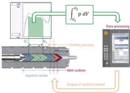
viscosità della resina regolando in continuo la pressione di iniezione in modo da restare nel range della curva ottimale di stampaggio (vedi grafico). Questa funzione sarà implementata, a scopo dimostrativo, su una pressa EcoPower 55/350 che stamperà mollette per bucato in polycarbonato utilizzando uno stampo a 4 cavità Lechner. La
