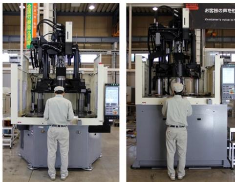
Tra i benefici di questa soluzione, il costruttore giapponese segnala la riduzione del 52% dell'olio idraulico necessario al funzionamento e la possibilità di installare robot e automazioni. Per la rotazione della tavola e l'estrazione vengono utilizzati servomotori, che rendono più veloce il ciclo e aumentano la precisione del movimento.
