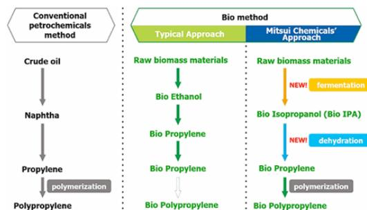
Mitsui Chemicals ha messo a punto un processo per ricavare questo polimero non da materie prime petrolchimiche, come avviene oggi, ma da biomasse non destinate a consumo umano, trasformate mediante fermentazione in isopropanolo (2-propanolo), un alcool che mediante disidratazione si trasforma in propilene, monomero del polipropilene.
