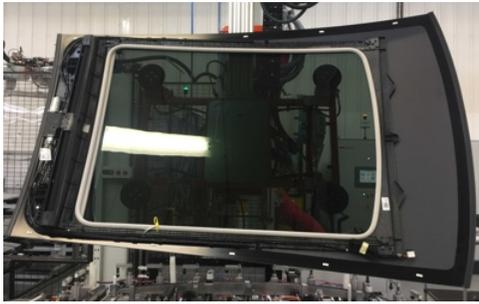
**METAL REPLACEMENT NELL'AUTO.** L'olandese Polyscope Polymers è stata premiata nella categoria Automotive (applicazioni) per la sostituzione delle guide in alluminio dei tetti apribili (foto a sinistra) con un composito a base di copolimero stirene-anidride maleica (SMA) e ABS rinforzato con il 15% di fibra di vetro, soluzione utilizzata da Webasto France e Renault sui modelli Scenic e Grand
