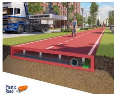
Si tratta di una sorta di scatolato prefabbricato cavo e leggero, all'interno del quale vengono fatti passare condotte e cablaggi, posato su un sottofondo sabbioso. Una soluzione tecnica che elimina tutti i problemi di sicurezza dovuti alle buche e al dissesto dell'asfalto, oltre a favorire il deflusso dell'acqua piovana in eccesso.
