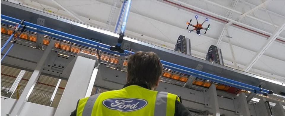
La casa automobilistica Ford sta sperimentando nel sito di Dagenham, nel Regno Unito, l'impiego di piccoli droni telecomandati per ispezionare le linee di produzione, in particolare le attrezzature più complesse o le parti più alte e meno accessibili dello stabilimento.
