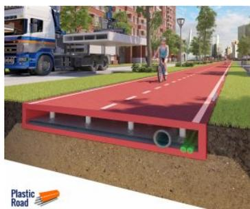
Nei mesi scorsi, i tre partner del progetto hanno condotto prove e ottimizzato il sistema, in termini di materiali (blend a base di plastiche riciclate) e design degli elementi prefabbricati, per assicurarsi che potesse sostenere i carichi previsti per un periodo di tempo sufficientemente lungo. Inoltre, sono stati condotti studi per ridurre l'impatto ambientale.
