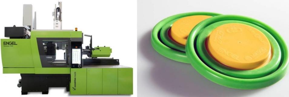
In occasione del prossimo Plast (Milano 29 maggio - 1° giugno 2018), nello stand Mesgo al Padiglione 11 sarà mostrato un esempio tecnologicamente avanzato di produzione automatizzata di guarnizioni a membrana, attraverso il sovrastampaggio di un inserto in PBT caricato fibra vetro con silicone platinico solido, materiali sviluppati entrambi dal compoundatore bergamasco.
