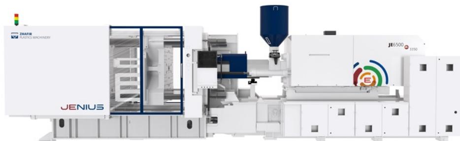
Il costruttore cinese di presse ad iniezione Haitian ha presentato a Chinaplas l'ultima nata del suo brand premium Zhafir, la pressa a due piani idrida Zhafir Jenius (JE) dotata di azionamento elettrico sull'unità di iniezione e gruppo di chiusura a due piani servoidraulico. La nuova serie sarà fornita in diversi modelli con forza di chiusura da 450 a 3.300 tonnellate.
