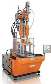
La pressa verticale ST-80-FT mostrata in Fiera sarà equipaggiata con sistema di sicurezza integrato, basato su fotocellule, e con cilindro di plastificazione da 45 mm, per un volume di iniezione pari a 316 cm<sup>3</sup> con vite da 120 mm e pressione massima di 1.411 kg/cm<sup>2</sup>; questa versione è in grado di montare stampi con base di 405x450 mm.
