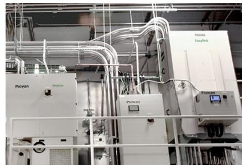
centraline di smistamento automatico Easylink, un sistema di aspirazione in vuoto – Varyo - che riduce gli stress sul materiale e otto chilometri di tubazioni in acciaio che percorrono come un sistema arterioso l'intero stabilimento; dove necessario, il granulo viene deumidificato grazie a quattro unità Modula che gestiscono 25 tramogge.
