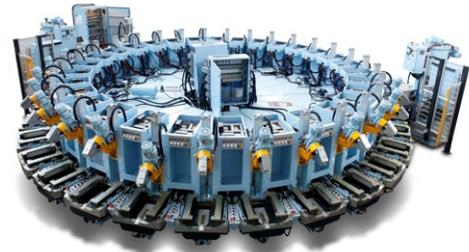
La nuova generazione di macchine modulari Pragma consente di iniettare direttamente sulla tomaia materiali combinati, quali gomma, TPU e PU compatto per il battistrada, sistemi poliuretanic per l'intersuola.
