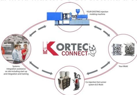
Si tratta - afferma il costruttore statunitense - di un modulo “plug and play” per il retrofit di presse esistenti, che contiene nella centralina di controllo tutti gli algoritmi e le impostazioni necessarie per il corretto funzionamento della macchina in co-iniezione. Basta aggiungere il gruppo E-Multi sulla pressa, effettuare necessarie le connessioni e avviare la produzione.
