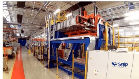
La linea, che opera su 32 modelli differenti di armadi, è costituita da una maschera di schiumatura e di due tamburi di asservimento. Nei tamburi trovano alloggio quattro maschi, versionabili in maniera automatica. La maschera utilizza la tecnologia a bocca in su che garantisce una schiumatura ottimale degli armadi, grazie al migliore riempimento e distribuzione della densità della schiuma nella cavità.
