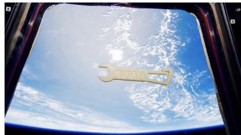
Nell'ambito del progetto Printing the Future, già da un anno il 'polietilene verde' a marchio l'm green di Braskem (ottenuto da bioetanolo) viene utilizzato sulla IIS per produrre pezzi e componenti con macchine appositamente sviluppate da Made In Space.
