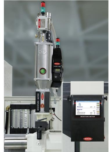
Lanciato in anteprima a Friedrichshafen e disponibile sul mercato l'anno prossimo, Moisture Meter Manager esegue il settaggio automatico delle variabili di processo senza necessità di ulteriori tarature off-line o interventi dell'operatore, evitando così possibili errori di impostazione.
