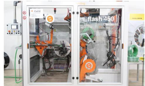
Sica, azienda ravennate specializzata nella costruzione di macchine automatiche per fine linea d'estrusione, propone entrambi i sistemi, consigliando la soluzione in film estensibile soprattutto - ma non solo - per il confezionamento di tubo corrugato. In questo segmento, propone due macchine compatte ed automatiche, Flash 700 e la più recente Flash 450, entrambe brevettate.
