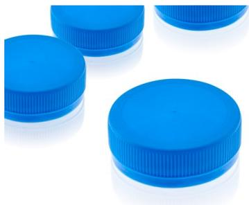
**INDUSTRIA 4.0 IN AZIONE.** Un'altra pressa, Elion 2200-1000, produrrà in fiera, in un'unica fase, chiusure in HDPE per bottiglie latte, collo da 38 mm (peso 2,8 grammi), dotate di banda tamper-evident. In ottica Industria 4.0, per la prima volta il controllo della pressa aXos sarà integrato con l'ispezione visiva CapWatcher III, grazie alla collaborazione avviata con Intravis, utilizzando per lo scambio dati il protocollo Euromap 82/OPC-UA. L'operatore può così
