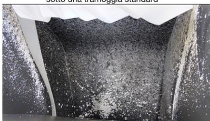
adatto al contatto con alimenti: la sua funzione è evitare che i residui di macinazione si accumulino sulle superfici trattate. Lo stesso convogliatore, incernierato alla tramoggia, è facile da aprire e il battente montato al suo interno viene rimosso con la stessa operazione. All'interno della camera di macinazione si trova una speciale piastra anti-rigurgito.
