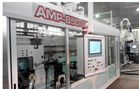
Le operazioni di forma e trancia avvengono simultaneamente utilizzando uno stampo di tipo basculante, a 55 cavità, con area di 850 x 560 mm; la forza di chiusura e formatura è pari a 70 tonnellate.
