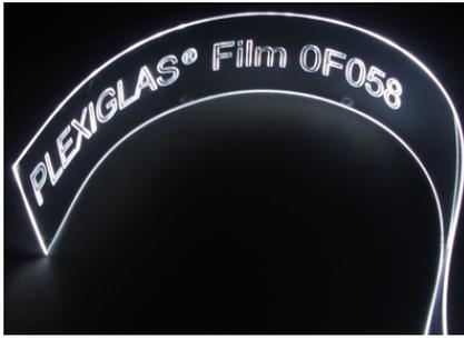
**QUALITÀ OTTICA.** Ciò che conta nel determinare la qualità di un display non è il peso, ma l'intensità della luce diffusa. "Grazie alle sue caratteristiche ottiche, il PMMA Plexiglas è un'eccellente materiale per la guida luce - sottolinea Parusel -. Le speciali strutture microscopiche impresse sul film indirizzano la luce dai micro LED sull'intera superficie, provvedendo così alla retroilluminazione dei display di tablet e smartphone, con un
