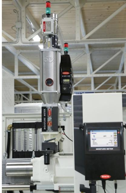
Meter BOX, CROWN, unità MDC e dryer permette di avere un completo controllo del processo: misurando il grado di umidità del polimero in entrata e in uscita dalla tramoggia è possibile adattare i parametri del dryer affinché soddisfino i requisiti tecnici stabiliti dal cliente.
