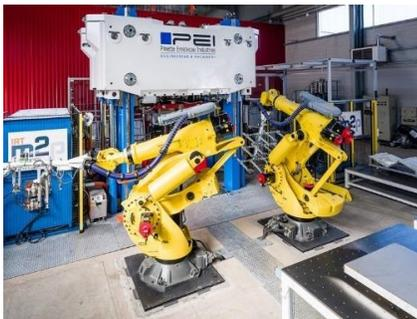
Processo: in questa categoria è stata premiata IRT M2P (Francia) per la tecnologia Fast RTM (foto a sinistra), sistema con carico e scarico automatizzato per la fabbricazione di parti strutturali per automobili di serie in composito utilizzando processi di trasferimento resina reattivi (RTM). Bastano 120 secondi per realizzare grandi componenti funzionali e strutturali in composito, con superficie fino a 3 metri quadrati. Per il controllo qualità, il sistema è dotato di strumentazione per
