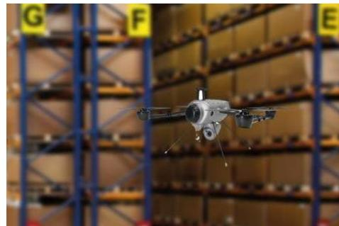
Geodis afferma che "il primo prototipo ha dimostrato tutte le potenzialità del sistema sviluppato che comprende un drone a quattro eliche equipaggiato con una videocamera ad alta risoluzione e un robot a terra dotato di una batteria che fornisce l'energia necessaria al sistema. Capace di identificare i pallet in condizioni di scarsa illuminazione, la soluzione viene gestita attraverso diversi sistemi elettronici e computer dedicati".
