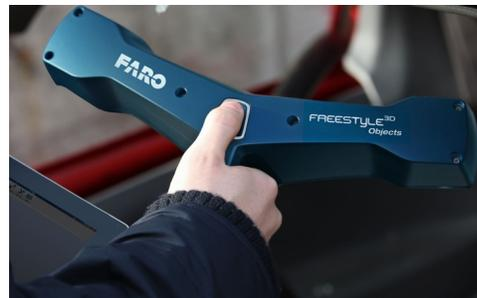
Oltre che per maneggevolezza e facilità d'uso, lo strumento si segnala per un'ampiezza di visione tra 0,3 e 0,8 metri, ideale per la scansione di componenti e oggetti di medie dimensioni, ottenendo una nuvola di punti a colori ad alta risoluzione. Una volta completata l'operazione, i dati possono essere inviati a SCENE Process 6.1, strumento di meshing su larga scala, oppure esportati per essere elaborati con altri software.
