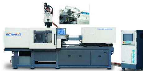
Al centro dell'installazione una pressa ad azionamento elettrico EC180SXII, con forza di chiusura di 176 tonnellate, equipaggiata con due unità di iniezione ausiliarie E-Multi di Mold-Master in grado di produrre due diversi componenti in differenti colori, prelevati e assemblati da due robot verticali Toshiba Machine (TV1000H e TVL700).
