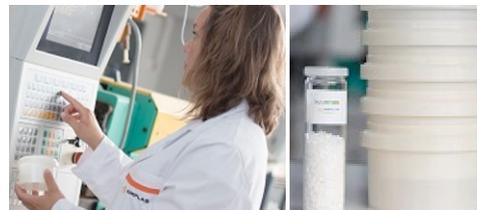
**PLA MODIFICATO.** Il team di ricerca, guidato dal Fraunhofer Institute for Chemical Technology di Pfinztal, in Germania, è riuscito a produrre acido polilattico da lattide utilizzando l'estrusore come reattore di polimerizzazione, ottenendo biopolimeri variamente additivati e caricati, più flessibili e con resistenza all'impatto pressoché raddoppiata rispetto al PLA standard.
