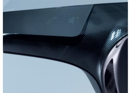
**COME FUNZIONA.** Con DirectCoating il pezzo viene prodotto in uno stampo bicomponente utilizzando un processo di iniezione a due stadi: nella prima cavità viene iniettata la resina; il manufatto così ottenuto viene trasferito nella seconda cavità, dove è rivestito con un coating poliuretanico mediante RIM (reaction injection molding), utilizzando una testa di miscelazione. Alla fine del ciclo, il componente esce dallo stampo finito, senza necessità di ulteriori lavorazioni.
